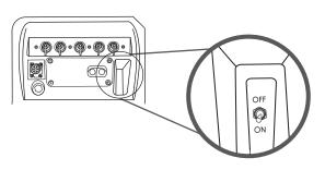
IF THE SWITCH IS NOT VISIBLE PUSH AWAY FROM THE SOLAR PANEL
